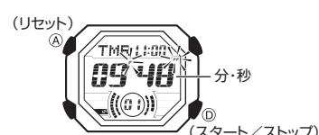
★計測トップ後Ⓐボタンを押すと、計測前の表示に戻ります（タイマー時間にリセット）。
