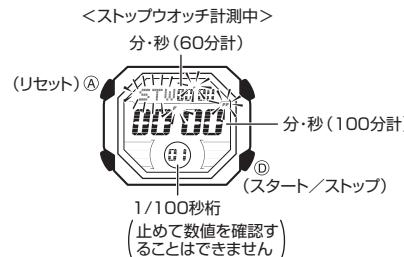
★計測中にⒶボタンを押すと、上段表示は止まりますが、下段表示は止まらずに計測を続けます。
