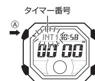
\*計測ストップ状態からはセット状態に切り替わりません。このようなときは、①ボタンを押してタイマー時間にリセットしてから、①ボタンを約1秒間押すとセット状態になります。
