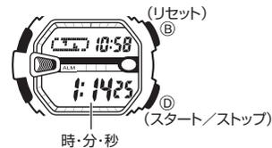
★ 計測ストップ後 **ⓑ** ボタンを押すと、計測前の表示に戻ります（リセット）。
