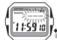
Ⓒ ボタンを押して点滅箇所を移動させ、Ⓓ または Ⓔ ボタンを押してセットする操作を繰り返して、時刻・カレンダーを合わせます。
