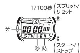
●計測中に◎ボタンを押すと、表示は止まりますが、内部では計測を続けるスプリット計測となります(SPL表示)。
