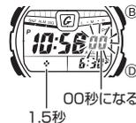
Ⓒボタンを押して点滅箇所を移動させ、ⒹまたはⒺボタンを押してセットする操作を繰り返して、時刻・カレンダーを合わせます。
