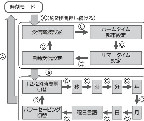
※セット状態(表示の一部が点滅)のときにⒶボタンまたはⒷボタン押すと、上記順に点滅箇所が移動します。
