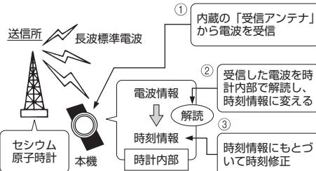
電波時計は正確な標準時を受信していますが、時計内部の時刻演算処理等により、時刻表示に1秒未満のズレが生じます。
