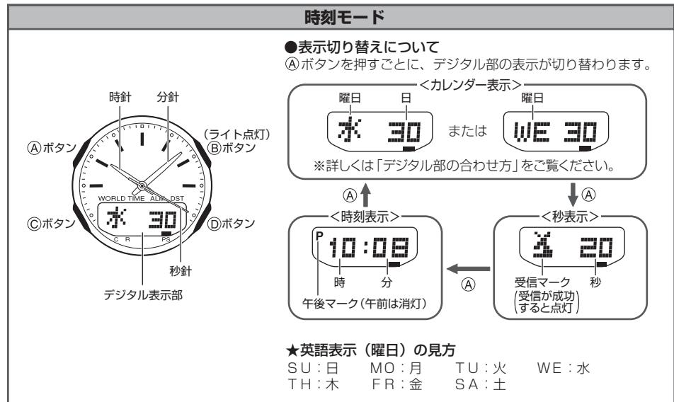
※バッテリーモード、アラームモード、ハンドセットモードのまま2~3分すると、自動的に時刻モードに戻ります。
