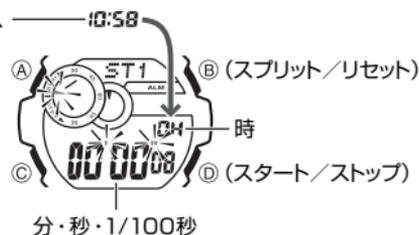
★ 計測中に **◎** ボタンを押すと、表示は止まりますが、内部では計測を続ける**スプリット計測**となります (“SPL” 表示)。
