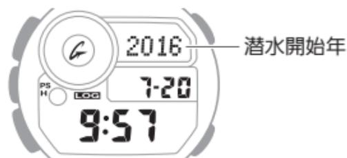
※ ① ボタンを押すと 2 秒間、記録した潜水開始日付 (年月日)、時刻を表示します。
