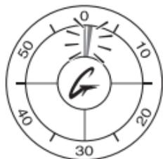
ダイビングモードの潜水時間の計測、ストップウォッチモード、タイマーモードでは1分単位で点滅します。
