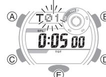
3. D ボタンと E ボタンを同時に 5 秒以上押し続け、[ALL] が点滅から点灯に変わったら指を離します。
