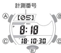
3. D ボタンと E ボタンを同時に 2 秒以上押し続け、[CLR] が点滅から点灯に変わったら指を離します。
