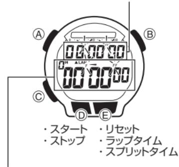
ストップウォッチの操作開始時には、分、秒、1/100秒を示します。ストップウォッチ計測時間が10時間を超えると、時、分、秒表示に変更します。
