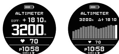
高度計測モードに切り替えると計測が始まり、現在地の高度が表示されます。
