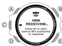
[GPS CAPTURE] に表示が切り替わり、GPS を使ったランニング計測が可能になります。
