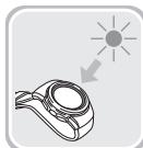
腕にしているときは、文字板(ソーラーパネル)に衣類の袖がかかるないように心がけてください。文字板(ソーラーパネル)が一部でも隠れていると発電効率が低下します。
