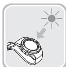
腕にしているときは、文字板(ソーラーパネル)に衣類の袖がかかるないように心がけてください。文字板(ソーラーパネル)が一部でも隠れていると発電効率が低下します。
