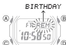
タイトルを一度表示すると、その後は日付のドットが点滅します。この状態のときに A ボタンを押すと、再度タイトルを表示できます。
