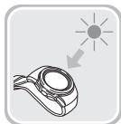
腕に付いているときは、文字板（ソーラーパネル）に衣類の袖がかからないように心がけてください。文字板（ソーラーパネル）が一部でも隠れると発電効率が低下します。
