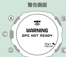
E ボタンを押して、計測開始をキャンセルすると GPS 受信画面に戻ります。
