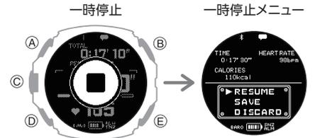
2. A または D ボタンを押して、タイマー計測していたインターバルトレーニングのデータをどうするか選びます。
