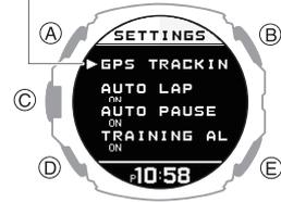
7. A または D ボタンを押して、[GPS TRACKING] にポインターを合わせます。
