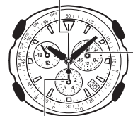
秒針が0位置に移動します。 0時0分(リセット位置)に移動します。
