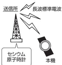
電波時計は正確な標準時を受信していますが、時計内部の時刻演算処理等により、時刻表示に1秒未満のズレが生じます。
