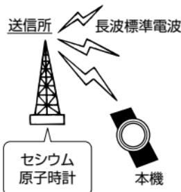
電波時計は正確な標準時を受信していますが、時計内部の時刻演算処理等により、時刻表示に1秒未満のずれが生じます。
