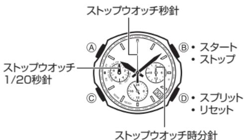
★ 計測中に④ボタンを押すと、針は止まりますが、内部では計測を続けるスプリット計測となります。
