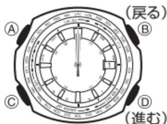
※ ①・②ボタンとも押し続けるとボタンを離しても連続して動き続ける早送り状態になります。早送り状態を止めるには、いずれかのボタンを押します。
