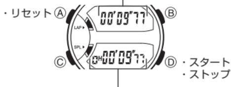
ストップウォッチの操作開始時には、分、秒、1/100秒を示します。ストップウォッチ計測時間が10時間を超えると、時、分、秒表示に変更します。
