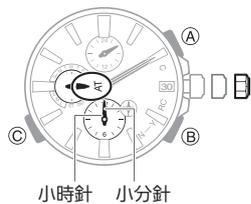
4. 小時計針、小分針および小時計針(24 時間制)が 12 時位置になっていないときは、りゅうずを回して小時計針と小分針を 12 時位置に合わせます。
