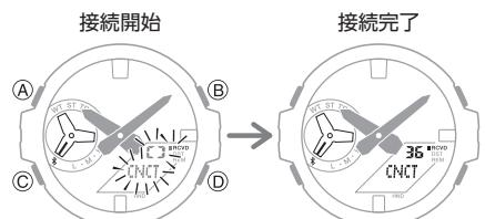
3. 画面に従って操作して、針の位置を補正します。
