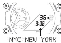
3. サマータイムの設定を変更する場合は、Aボタンを2秒以上押し続け、現在のサマータイム設定が点滅したら指を離します。
