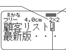
作っているラベルのレイアウト (イメージャー表示) 線の数は行数を表わし、線の太さは文字の大きさをイメージで表します。
