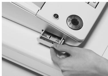
2 単3型アルカリ乾電池3本を、＋が右図と同じになるよう正しくセットします。
