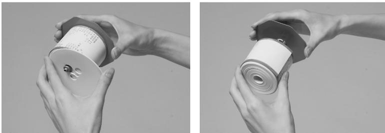
左の側板をずらして外し、軸押さえを外します。
